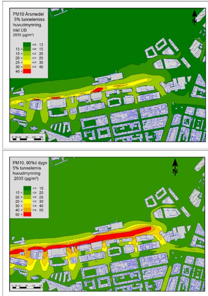
Figur 18. Beräknade totala halter av PM10 ( \mu\text{g}/\text{m}^3 ) i markplan för års-, dygnmedelvärde. Utgångspunkt är ett värsta fall där 95% av Götatunneln ventileras via ventilationstorn. Källa: Tillägsrapport Luftutredning, Cowi 2017-11-26.
