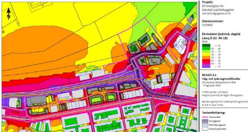
Figur 13. Exempel på bullerberäkning för väg- och spårvagnstrafik ekvivalentnivå dagtid. Samtliga bullerberäkningar framgår av planhandlingarnas bullerutredning Källa: Bullerutredning - verksamhets och trafikbuller 2017-12-21
